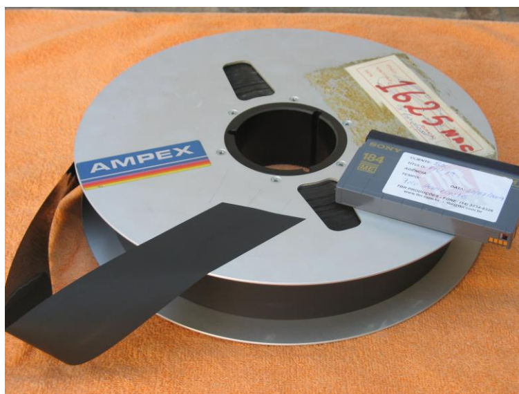
Fig. 16 – Fita quadruplex duração 60 minutos comparada com a DVCam para até 180 minutos Fonte: foto do autor
