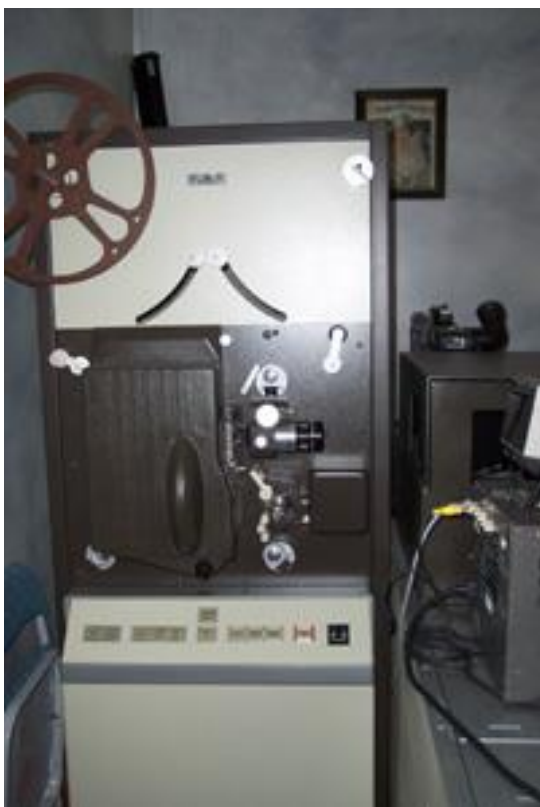
Fig.01 – Projetor TP 66 do telecine RCA
