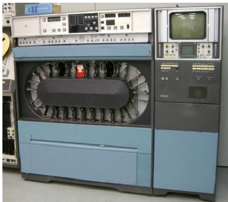
Fig.13 – VT RCA modelo TCR 100 – Exibidor de comerciais e vinhetas por cartucho com fitas de duas polegadas Fonte: http://www.chalkhillmedia.org/Museum
