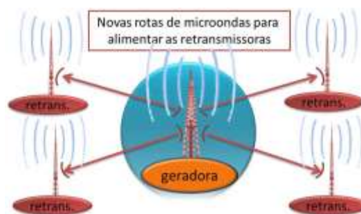
Fig. 2 – Rota de Microondas para alimentação de sinal nas retransmissoras
