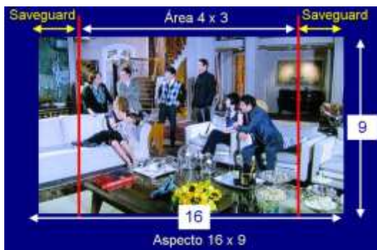
Fig. 3 - Saveguard aplicado em cena da novela Passione - Rede Globo Esquema produzido pelo autor
